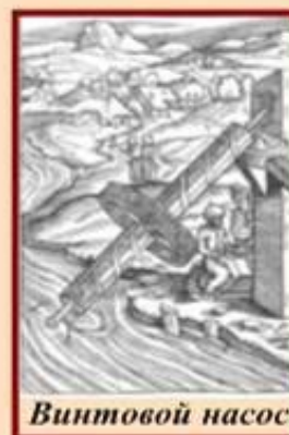
«Архимедов винт» - мощный и одновременно очень простой винтовой насос
