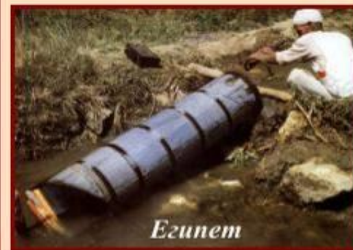
«Архимедов винт» - мощный и одновременно очень простой винтовой насос
