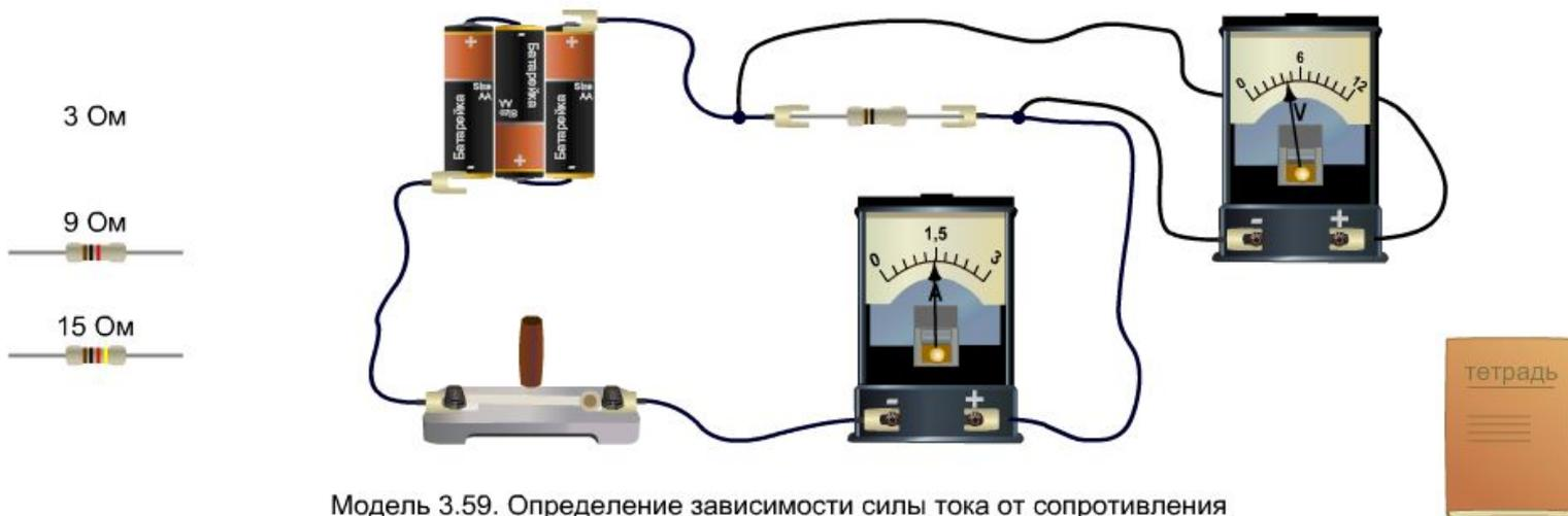
Модель 3.59. Определение зависимости силы тока от сопротивления
