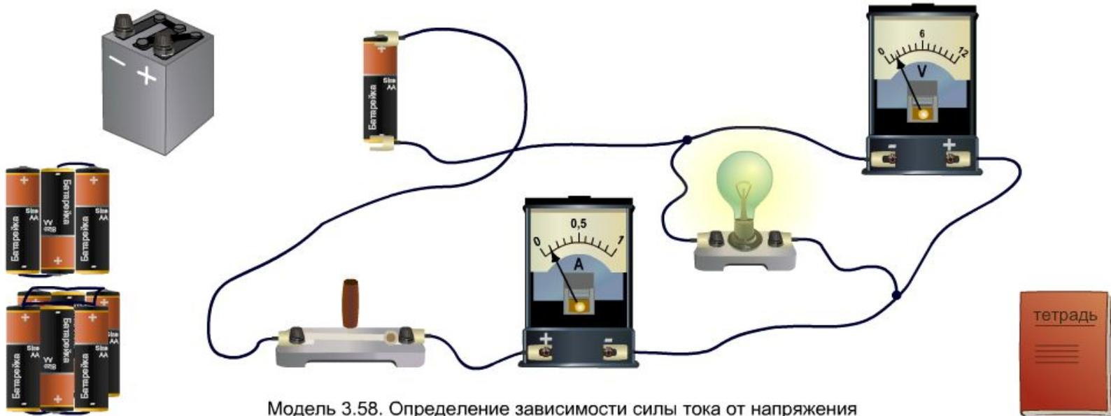
Модель 3.58. Определение зависимости силы тока от напряжения
