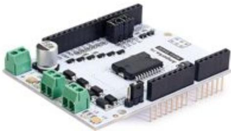
Motor Shield — плата расширения для Arduino на базе чипа L298P, позволяющая управлять моторами с напряжением 5–24 В в режиме отдельного питания и 7–12 В в режиме объединённого питания.
