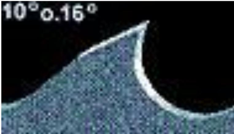
Форма MASTER. Зуб изготавливается в двух исполнениях по переднему углу  $10^\circ$  и  $16^\circ$ . Имеет продольно шлифованную фаску, что улучшает шероховатость обрабатываемой поверхности. Пилы с такой формой зуба предназначены для резки сплошных прутков из высоколегированных сталей.
