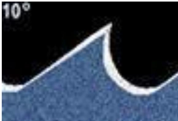
Форма HOOK (H). Зуб имеет передний угол  $10^\circ$ . Пилы с такой формой зуба предназначены для резки сплошных прутков, толстостенных труб из легированных сталей.
