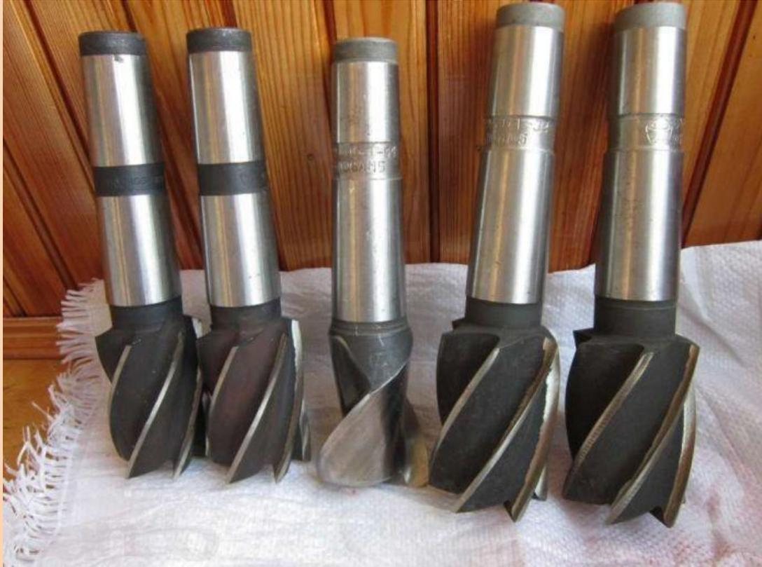
Для обработки пазов, уступов и так далее.
