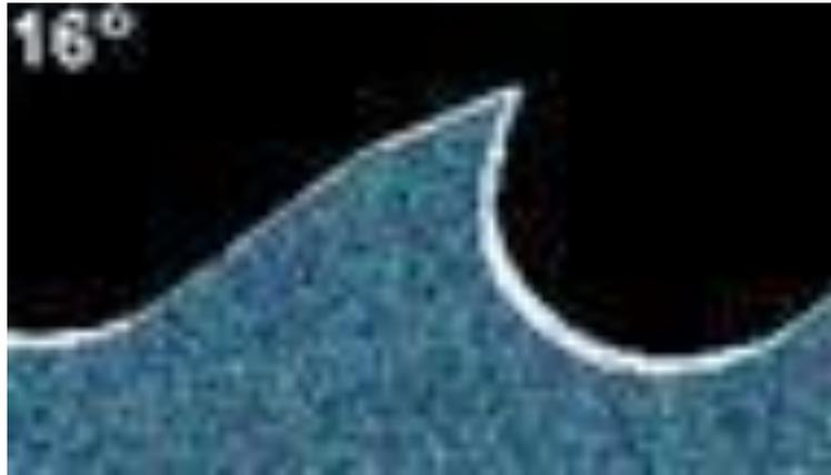
Форма RP. Зуб имеет передний угол  $16^\circ$ . Пилы с такой формой зуба предназначены для агрессивной резки сплошных прутков из высоколегированных сталей, трудно обрабатываемых металлов и цветных сплавов.
