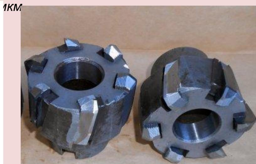
Рис. – Зенкер насадной со вставными тв. спл. ножами
