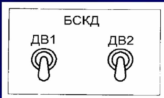
БСКД включается выключателем БСКД ДВ1 (ДВ2), расположенным на щитке включения систем в кабине экипажа. При этом включается непрерывный контроль системы от ВСК. Основной канал БСКД получает электропитание от основных шин переменного тока и от отключаемых шин постоянного тока.
