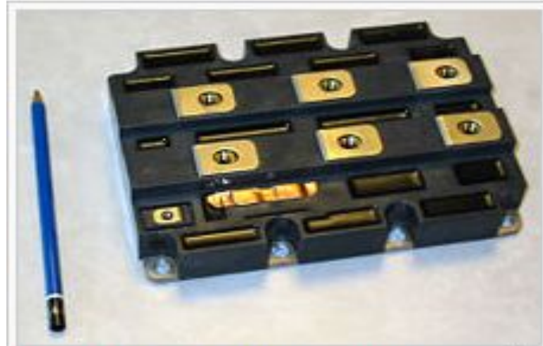
Сборка на БТІЗ для комутації напруги до 3300 В і токів до 1200 А.
