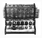
Необходимость автоматизировать вычисления при переписи населения в США подтолкнула Генриха Холлерита к созданию в 1888 году табулятора, где информация, нанесенная на перфокарты, расшифровывалась электрическим током. Это устройство позволило обработать данные переписи населения всего за три года, вместо затрачиваемых ранее восьми лет. Вскоре в 1924 году Холлерит основал фирму IBM для серийного выпуска табуляторов
