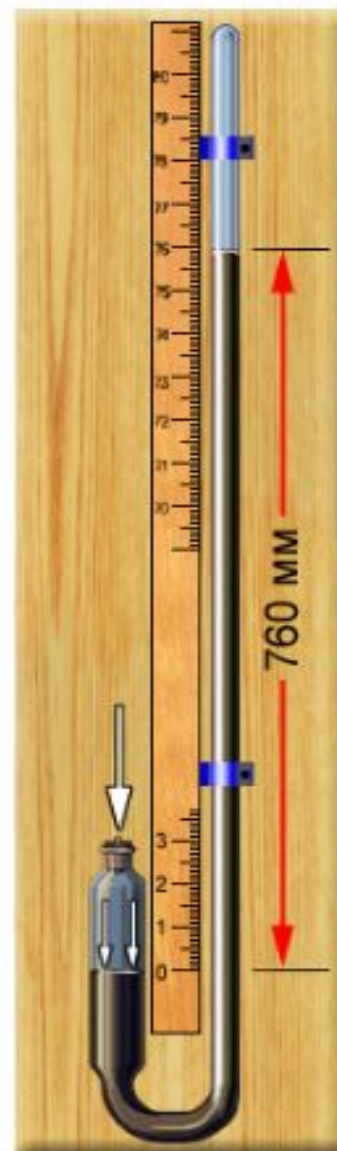
СХЕМАТИЧЕСКОЕ УСТРОЙСТВО РТУТНОГО БАРОМЕТРА
