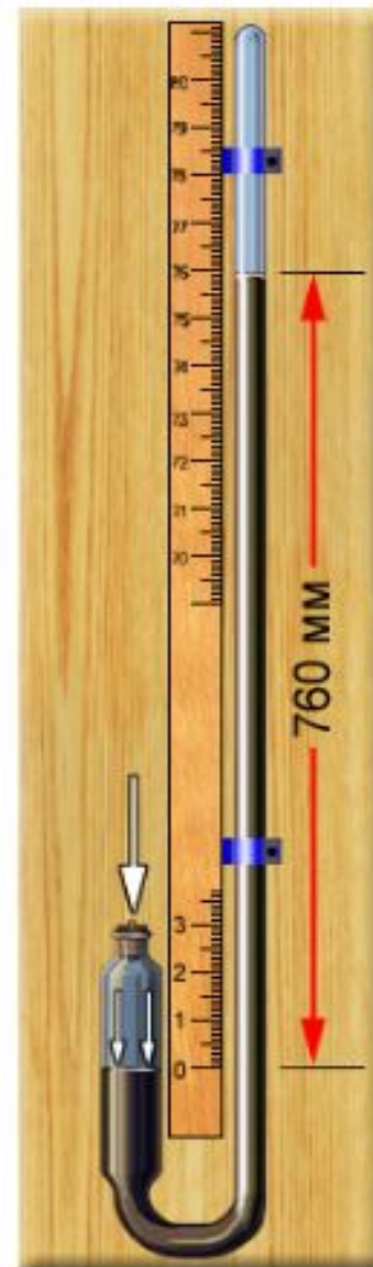
СХЕМАТИЧЕСКОЕ УСТРОЙСТВО РТУТНОГО БАРОМЕТРА
