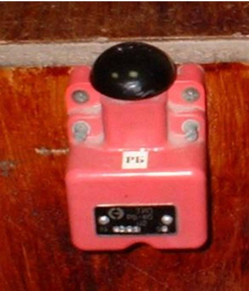
Кнопка, которую устанавливают на пульте машиниста. Когда раздается свисток ЭПК машинист должен ее нажать и отпустить, чтобы прекратить свисток. Свисток продолжается 6-7 секунд, если машинист не успеет нажать на кнопку, то произойдет экстренная остановка поезда. Остановку производит ЭПК разряжая тормозную магистраль.
