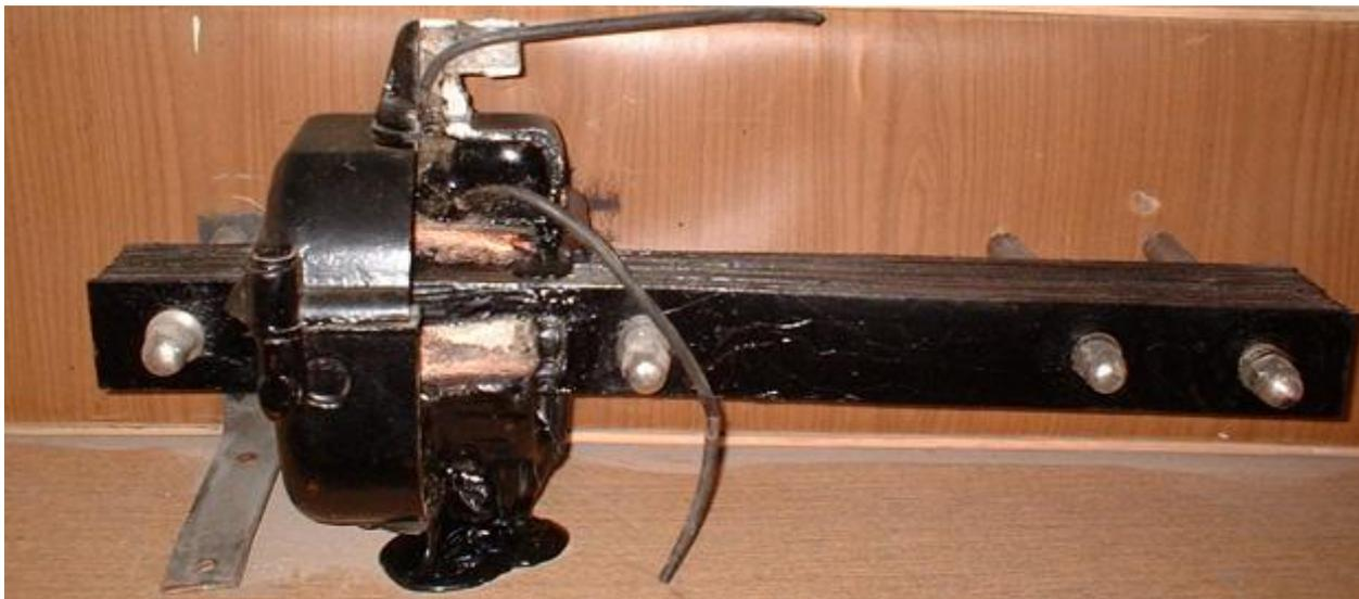
принимают сигналы, передаваемые по рельсам и передают их в усилитель
