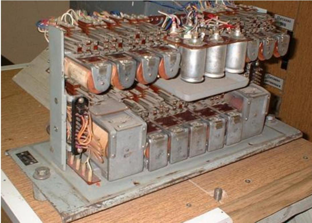
Производит дешифрацию числового кода в сигналы, которые показывает локомотивный светофор .
