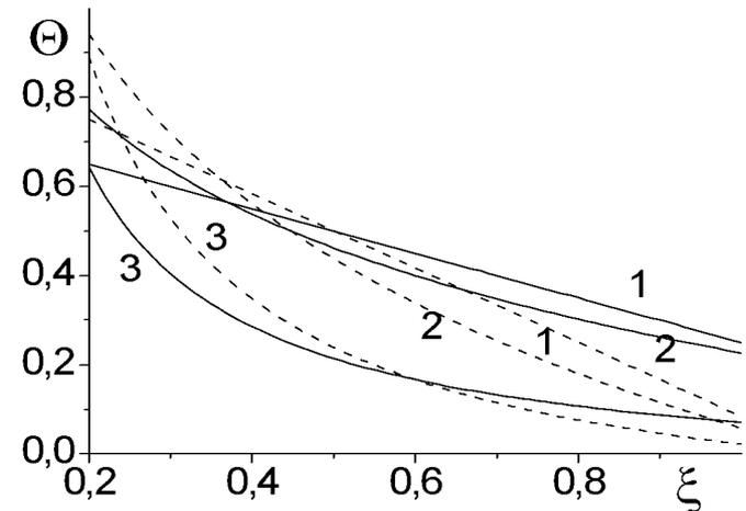
Распределение температуры вдоль координаты в плоской (1), цилиндрической (2) и сферической (3) стенках в условиях конвективного теплообмена. Сплошные линии -  $Bi = 2$  ; пунктирные -  $Bi = 10$
