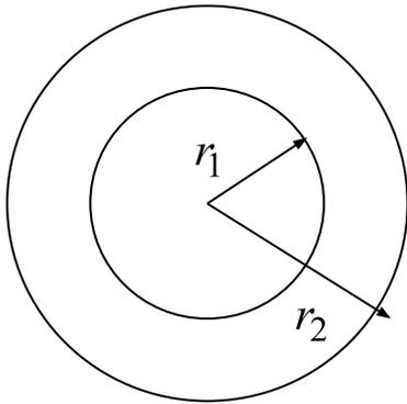
Радиальный тепловой поток в трубе обратно пропорционален логарифму наружного радиуса (возрастает сопротивление радиальной проводимости);
