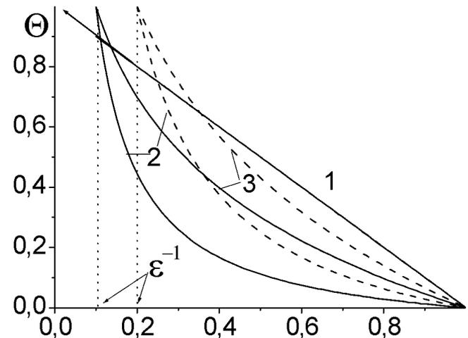
Распределение температуры в плоской (1), цилиндрической (2) и шаровой (3) стенке. Сплошные линии  $\varepsilon = 10$  ; пунктирные линии -  $\varepsilon = 5$
