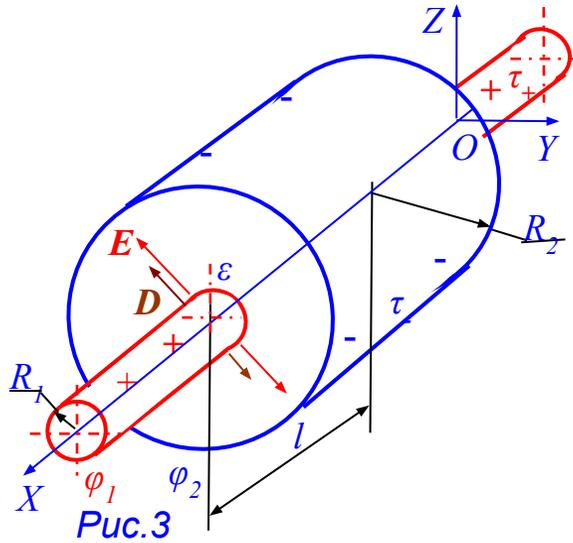
Разность  $\varphi_1 - \varphi_2$  потенциалов между цилиндрическими обкладками конденсатора, каждая из которых имеет  $\tau_+$ ,  $\tau_-$  линейные плотности зарядов и поэтому на каждой обкладке имеется  $q_+ = \tau_+ l$ ,  $q_- = \tau_- l$  свободный заряд
