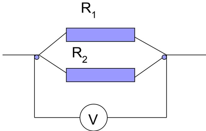
При параллельном соединении элементов цепи напряжение на всех участках одинаковое
