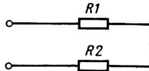
4. Определите общий ток  $I$  и ток  $I_1$  (рис. 2), если  $R_1 = R_2 = 10 \text{ Ом}$ ,  $U = 10 \text{ В}$ .
