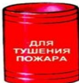
**ЕМКОСТЬ ДЛЯ ВОДЫ** должен быть объемом не менее 0,2 м<sup>3</sup> и комплектоваться крышкой и ведром. Не реже 1 раза в 10 дней вода должна пополняться, а 1 раз в квартал полностью меняться.
