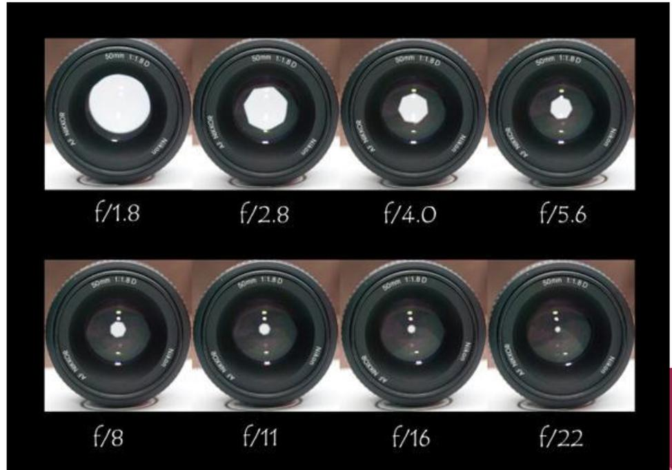
Диафрагма так же служит для ограничения количества света попадающего в итоге на матрицу объектива. То есть выдержка и диафрагма выполняют одну задачу — регулирование потока света попадающего на матрицу. Зачем же использовать именно два элемента?
