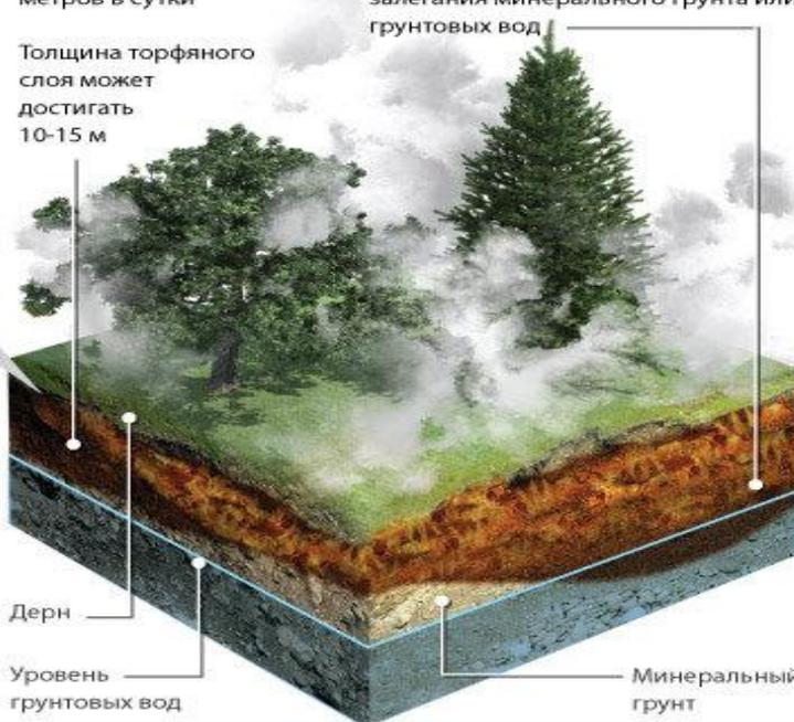
Распространение пожара в глубину ограничивается глубиной залегания минерального грунта или грунтовых вод
