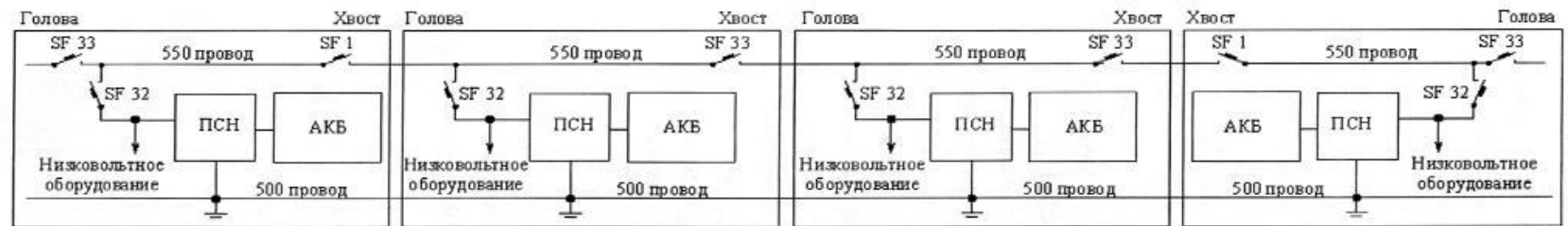
Рис.1 Схема 550 поездного провода
