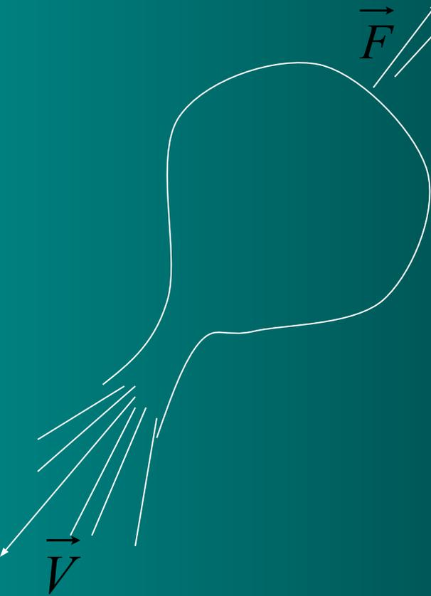
Под реактивным движением понимают движение тела, возникающее при отделении некоторой его части с определенной скоростью  $V$  относительно тела, например при истечении продуктов горения из сопла реактивного летательного аппарата. При этом появляется так называемая реактивная сила  $F$ , толкающая тело.
