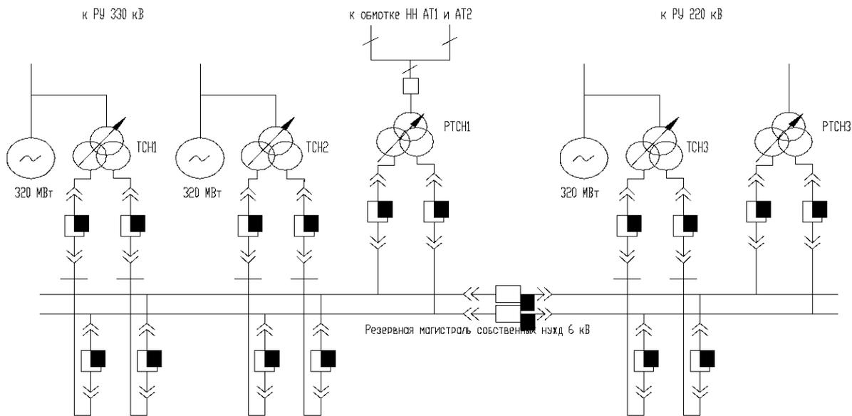
Рабочие трансформаторы собственных нужд блочных КЭС присоединяются отпайкой от энергоблока. Мощность трансформаторов определяется по формуле:
