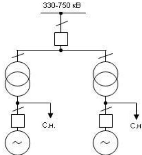
С целью упрощения и удешевления конструкции РУ 330-750 кВ применяется объединение блоков с отдельными трансформаторами под общий выключатель генераторные выключатели необходимы для включения генераторов на параллельную работу без использования РТСН. В этом случае при отключенном выключателе генератора питание на шины с.н. подаётся через блочный трансформатор и рабочий трансформатор с.н. После всех операций по пуску генератор синхронизируется и включается генераторным выключателем.
