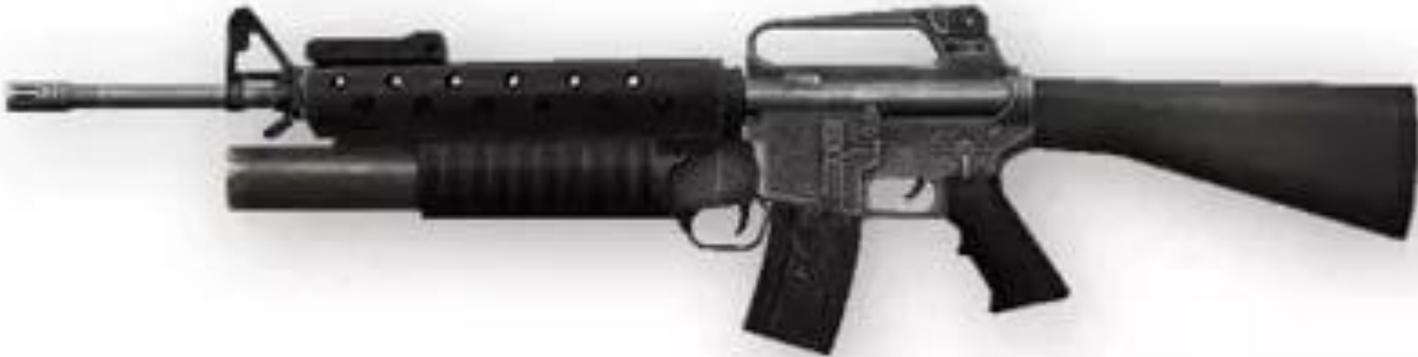
Подствольный гранатомет М203 разработан фирмой ААІ для применения с автоматами М16 и М4 и представляет из себя нарезное однозарядное огнестрельное оружие. Заряжается с казенной части, при перемещении кожуха. Для прицеливания используются приспособления, монтируемые на саму винтовку.
