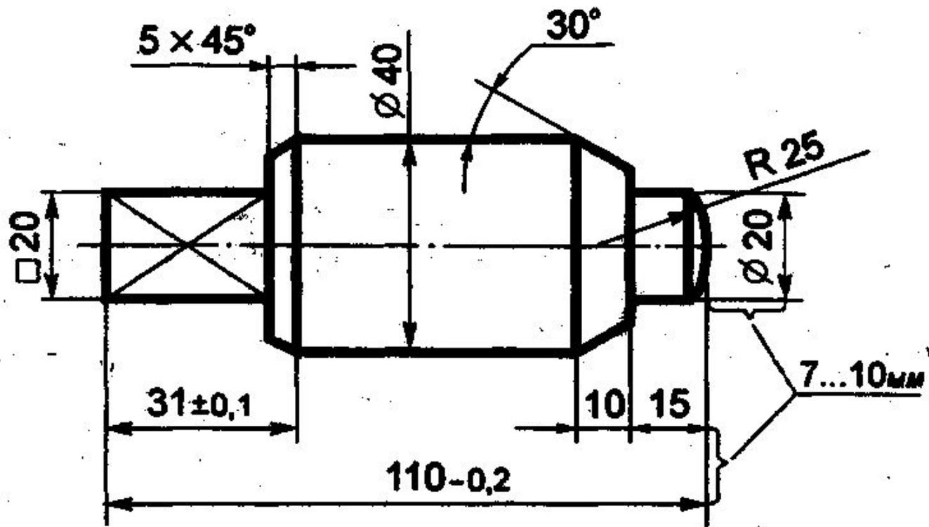
НАНЕСЕНИЕ РАЗМЕРОВ НА
