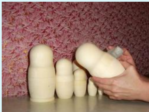
Деревянную матрёшку зачищают и грунтуют
