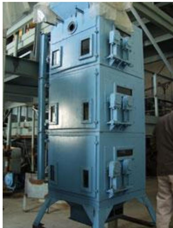
Рис. 3.59. Каскадный электростатический сепаратор
