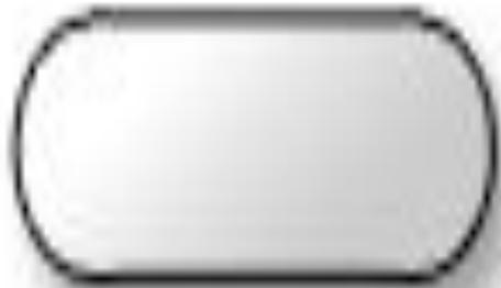
Элемент отображает выход во внешнюю среду и вход из внешней среды (наиболее частое применение – начало и конец программы). Внутри фигуры записывается соответствующее действие.
