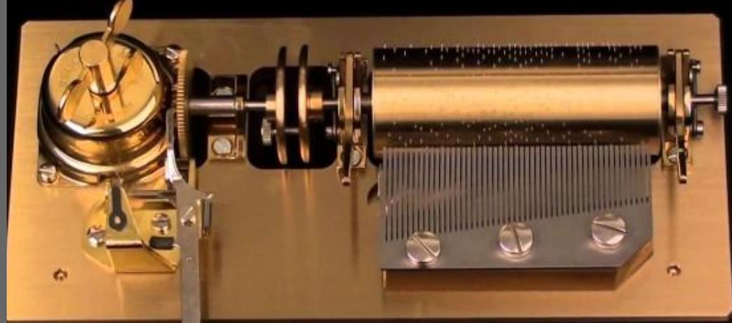
Устройство музыкальной - цилиндр со штырьками, станина, на которую установлены все детали, плоская гребенка и рукоятка. Хотя устройство более сложных музыкальных шкатулок включает в себя еще и колокольчики, а также барабан.
