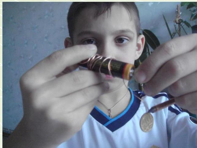
**Предлагаю вашему вниманию электромагнит, сделанный своими руками. Он состоит из гвоздя, проволоки и батарейки. Я намотал проволоку на гвоздь, соединил ее концы с батарейкой и магнит готов. Действие этого электромагнита я испытал. Он работает.**
