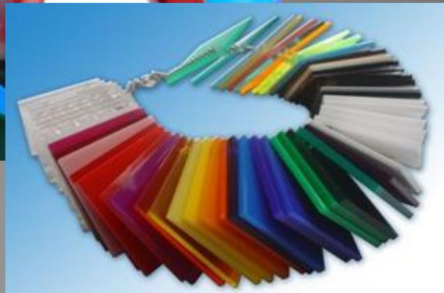
**Пластмассы** – это синтетические материалы, получаемые на основе органических и элементоорганических полимеров. Свойства пластмасс определяются свойствами полимеров, составляющих их основу.
