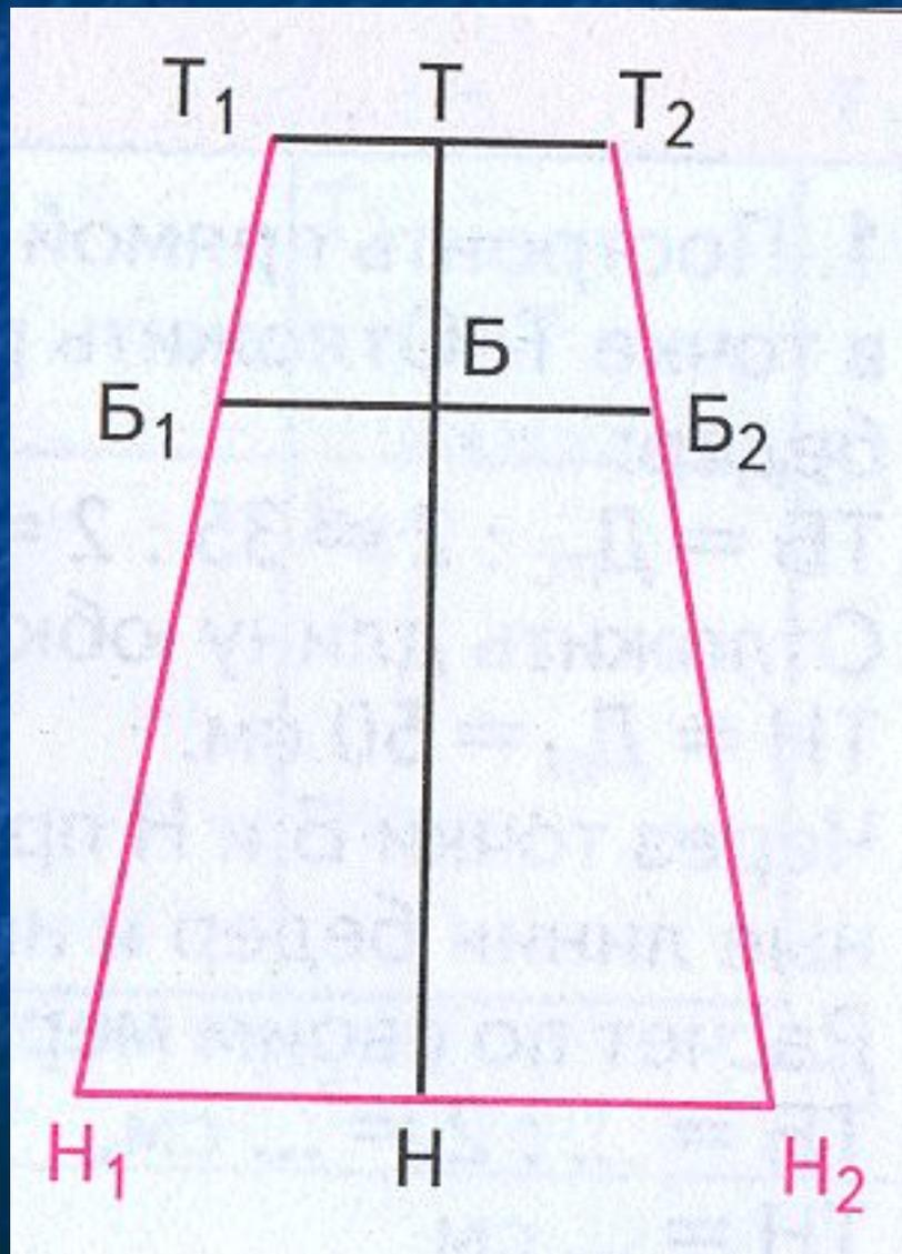
От точек Т и Н отложить вниз по 0,5 см. Обвести контур чертежа сплошной основной линией, оформляя линию талии и низа плавными кривыми
