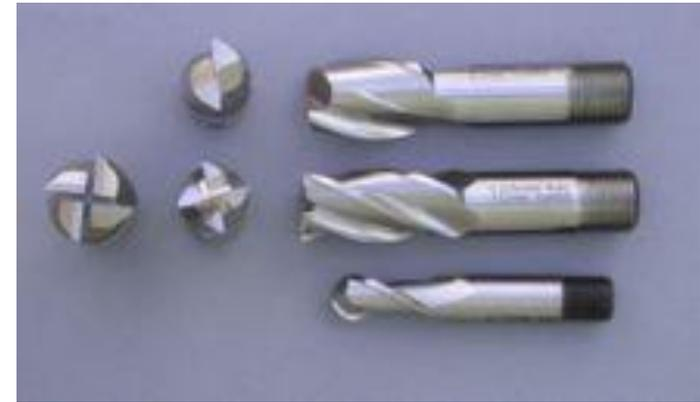
Металлорежущий инструмент фрезерной группы станков. Концевые фрезы.
