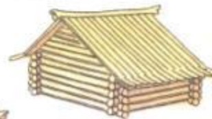
Двускатная кровля с полицами
