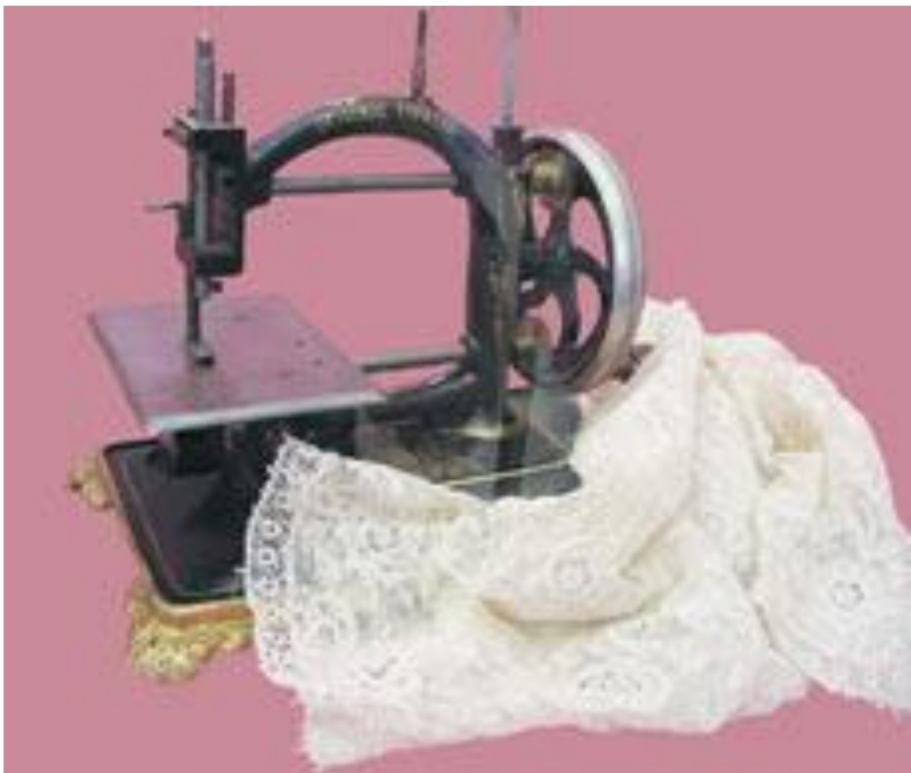
Швейная машина „Оригиналь экспресс“ цепного стежка (США, 1860-1880). Основание выполнено в технике художественного литья, что соответствует технической моде второй половины XIX века.
