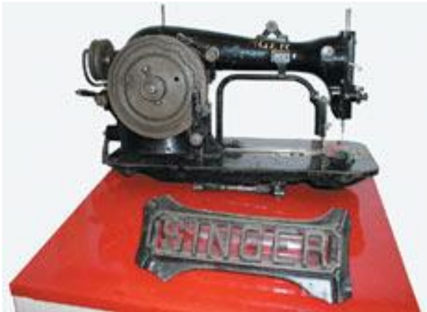
Швейная машина фирмы „Зингер“ (США, 1900-1915), предназначенная для изготовления закрепок и укрепления петель, пришивания бантиков к обуви и платью.
