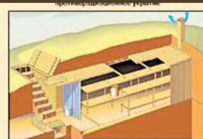
Отдельно стоящее противорадиационное укрытие из лесоматериалов
