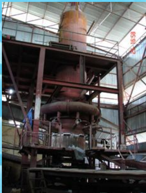
Шахтная печь компании Miruso Mining Co в Демократической Республике Конго и выпуск черновой меди
