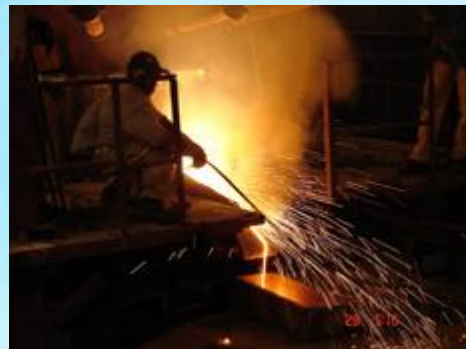
Шахтная печь компании Miruso Mining Co в Демократической Республике Конго и выпуск черновой меди
