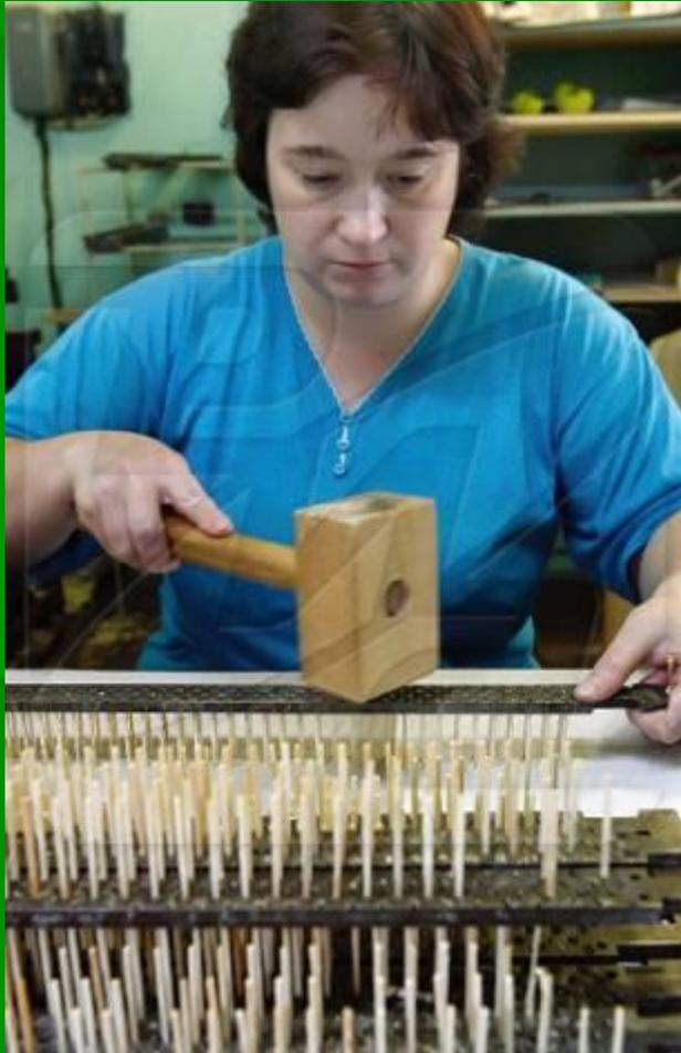
Для производства спичек используется древесина сосны. Сначала древесину распиливают на чурки и пропаривают для того, чтобы снять с них кору. Затем на специальном оборудовании получают древесную ленту, которую делят на спичечную соломку. Соломку нужно пропитать раствором фосфорной кислоты, чтобы исключить тление.
