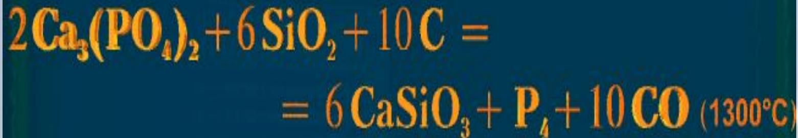
В промышленности фосфор получают из фосфоритов и апатитов. Метод основан на реакции восстановления  $\text{Ca}_3(\text{PO}_4)_2$  коксом до фосфора. Для связывания соединений кальция добавляют кварцевый песок ( $\text{SiO}_2$ ). Процесс проводят в электропечах. Продукт реакции - белый фосфор, который затем длительным нагреванием превращают в красный.
