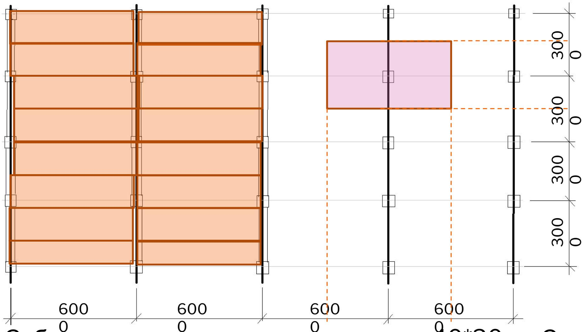
Собрать нагрузки на колонну сечением  $40 \times 30$  см. С опиранием ригеля сечением  $40 \times 50$  см. Строительство производится во II снеговом районе, производится строительство кафе, конкретно обеденного зала.
