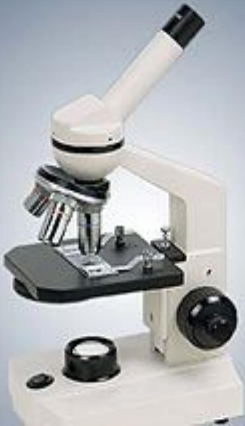
МИКРОСКОП (от микро... и греч. skopeo — смотрю), инструмент, позволяющий получать увеличенное изображение мелких объектов и их деталей, не видимых невооруженным глазом. Увеличение микроскопа, достигающее 1500-2000 раз.
