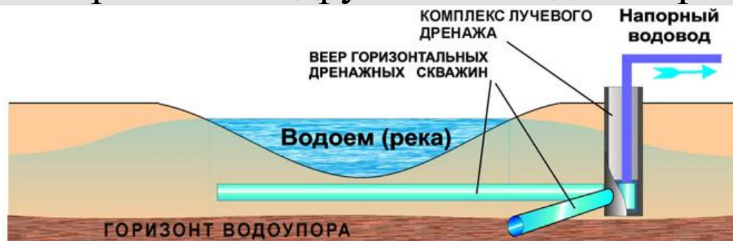
Схема подрусового водозабора, сооруженного методом лучевого дренажа
