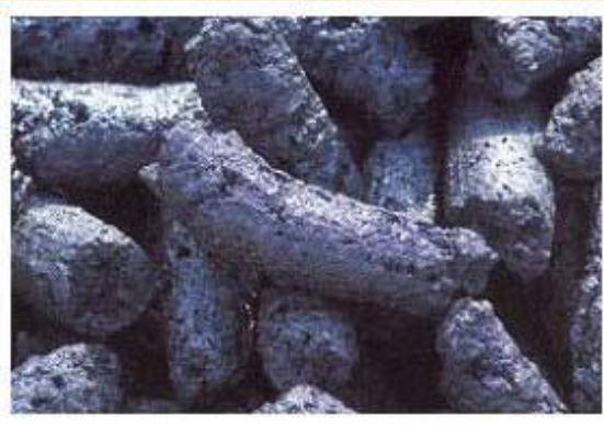
Гранулы диаметром: 32 - 45 мм, длина макс. 250 мм
