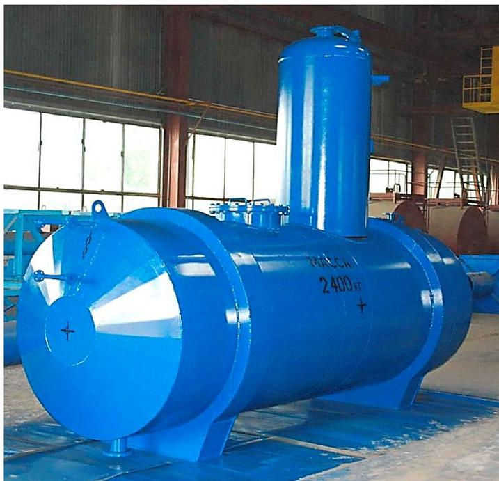
Десорбционный метод удаления кислорода реализуется в термических деаэраторах, в которых происходит нагрев воды паром до температуры ее кипения при одновременном равномерном разбрызгивании жидкости и
