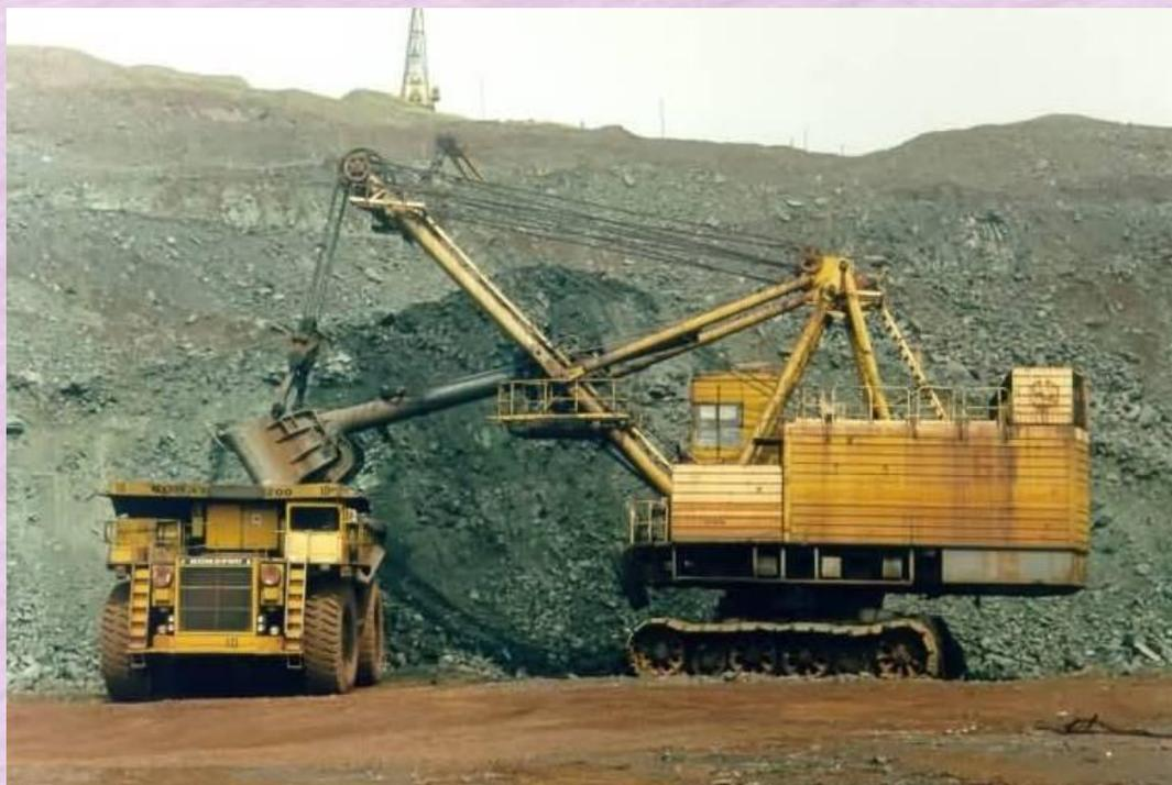
А после мощный экскаватор ковшом грузоподъемностью 20-25 т. грузит руду на карьерные самосвалы ("Белаз", "Камацу" с грузоподъемностью 120-130 тонн).
