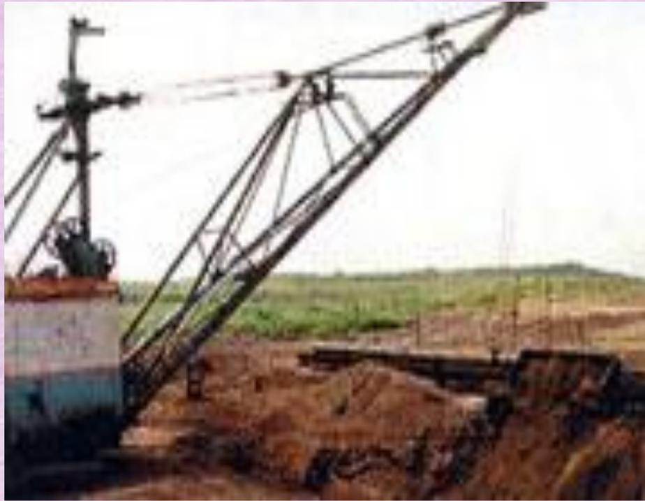
Найдя руду, начинают вскрытие месторождения – это удаление горных пород, покрывающих полезное ископаемое, при открытой разработке шагающим экскаватором.
