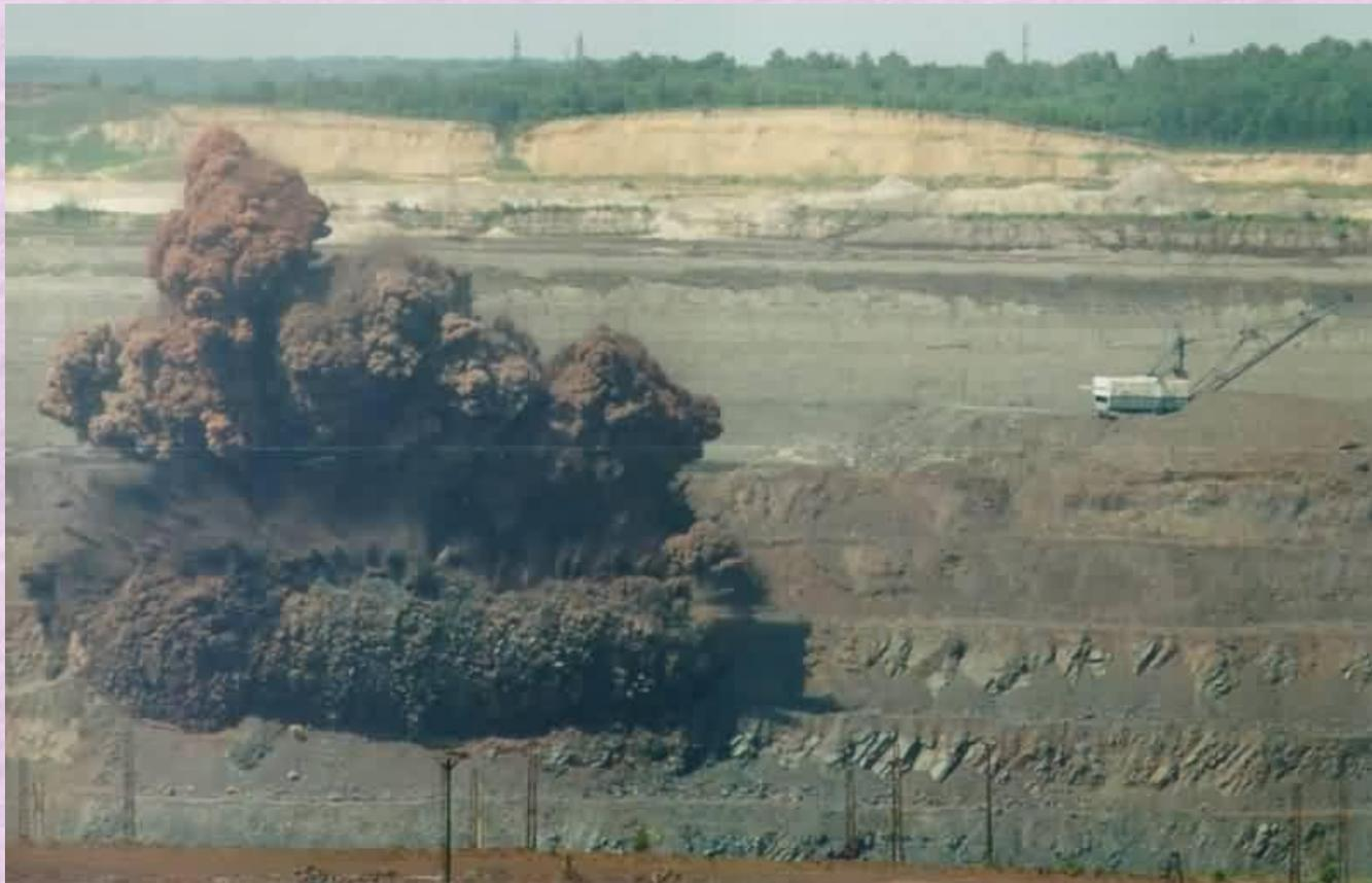
Затем осуществляется бурение в рудных забоях скважин для взрывных работ и производится взрыв разбуренного блока (100-150 т.)
