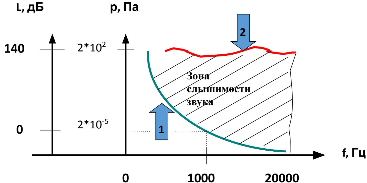
Порог слышимости (1) зависит от частоты, а порог болевого ощущения (2) имеет слабую частотную зависимость. Уровень звука на пороге слышимости равен 0дБ при звуковом давлении  $2 \cdot 10^{-5}$  Па, а на пороге болевого ощущения 140дБ при звуковом давлении  $2 \cdot 10^2$  Па. Область, расположенная между порогами, называется зоной слышимости звука.
