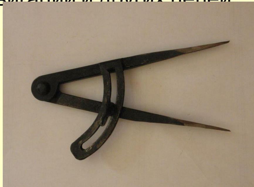
Пропорциональный Циркуль — инструмент для уменьшения (или увеличения) отрезков, а также для деления их на равные части. Пропорциональный циркуль состоит из двух стержней, шарнирно скрепленных между собой и несущих на себе шкалы наиболее распространенных отношений.
