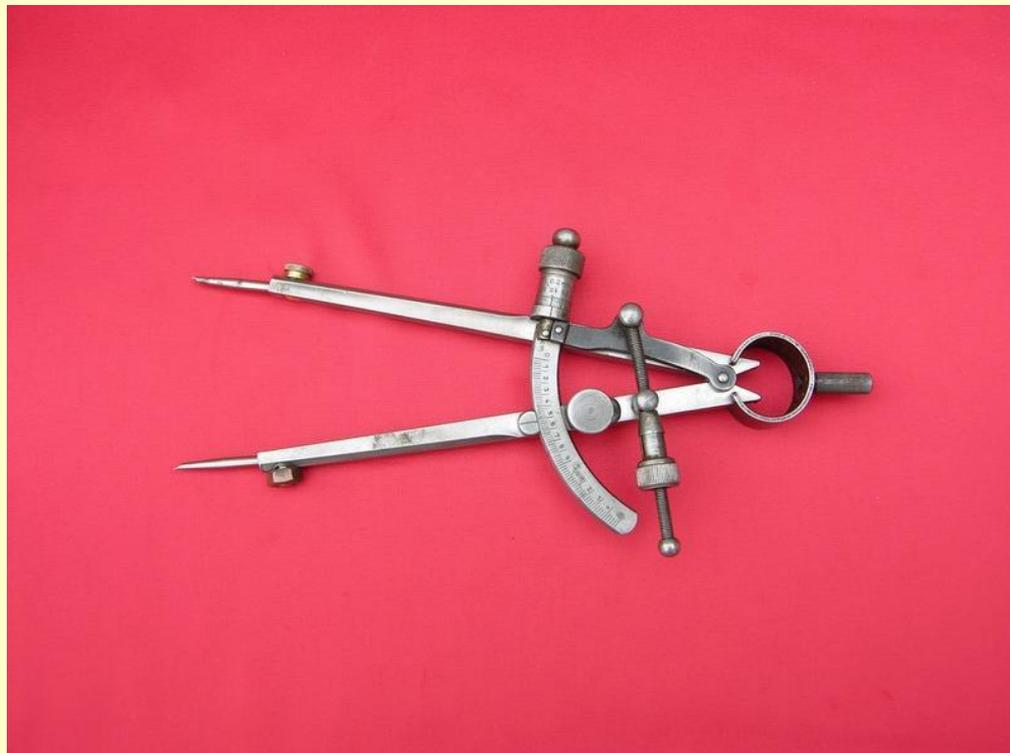
**Циркуль** — инструмент для рисования окружностей и дуг окружностей, также может быть использован для измерения расстояний, в частности, на картах. Может быть использован в геометрии, черчении для навигации и других целей
