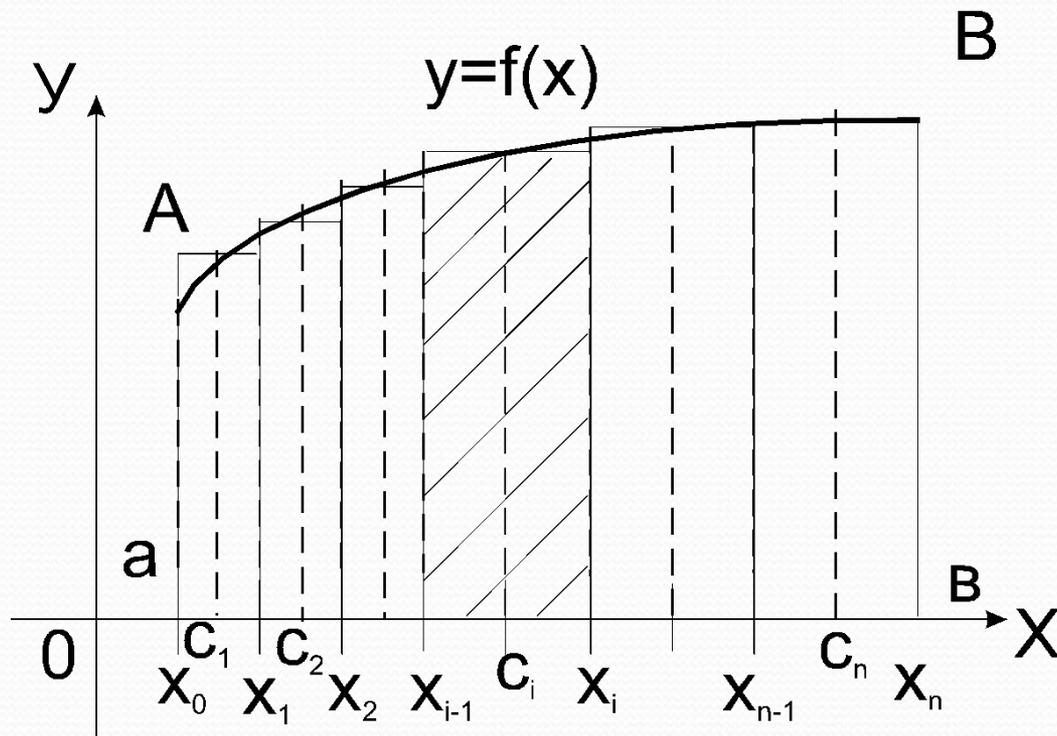
На каждом из частичных отрезков  $[x_{i-1}; x_i]$  выберем произвольно точку  $c_i$ ; а также на каждом частичном отрезке  $[x_{i-1}; x_i]$  построим прямоугольник, который при вращении вокруг оси  $Ox$  опишет цилиндр с высотой  $\Delta x_i$  и радиусом основания  $f(c_i)$ , объем которого
