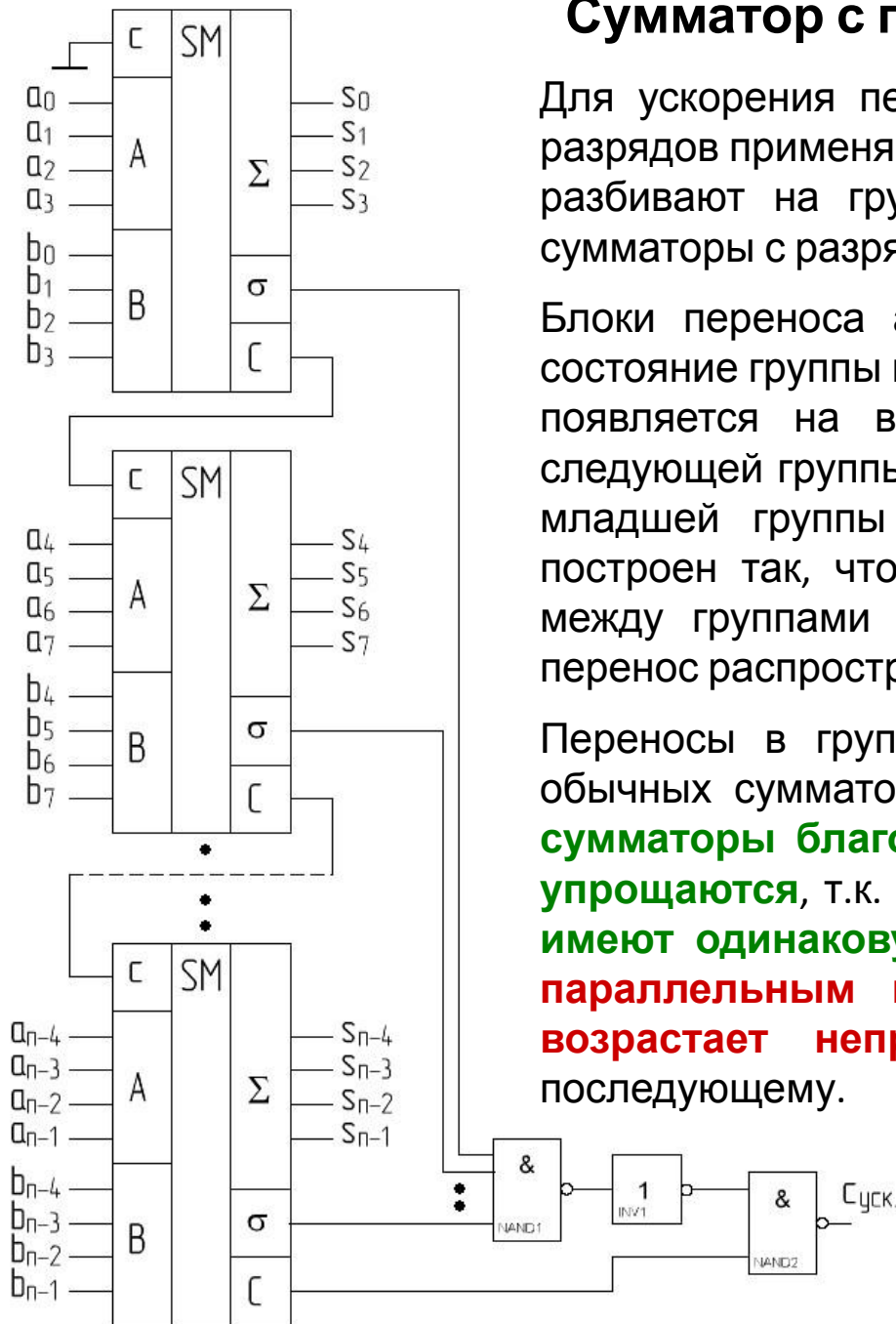
Схема формирования сигналов группового переноса
