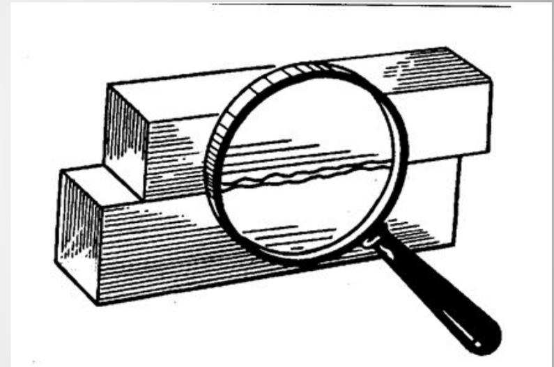
Шероховатость обработанной поверхности по направлению траектории относительно рабочего движения и перпендикулярно ей - различна.
