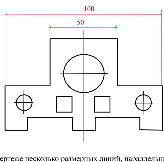
Если на чертеже несколько размерных линий, параллельных друг другу, то ближе к изображению наносят меньший размер.
