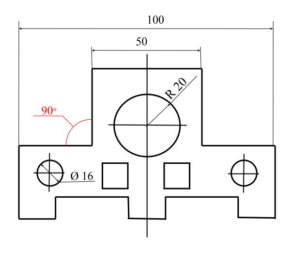
При указании размера угла, размерную линию проводят в виде дуги окружности, с центром в вершине угла.
