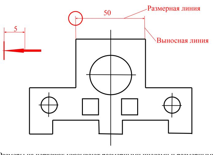
1. Размеры на чертежах указывают размерными числами и размерными линиями. Размерная линия ограничивается с двух сторон стрелками. Выносные линии выходят за концы на 1...5мм. Над размерной линией, ближе к середине, наносят размерное число
