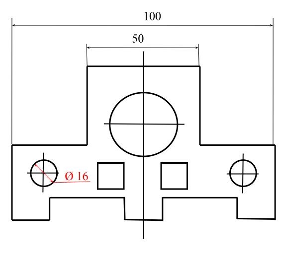
Для обозначения диаметра перед размерным числом наносят специальный знак  $\emptyset$ .
