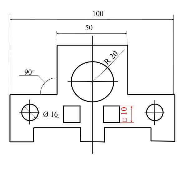
Перед размерным числом, указывающим сторону квадратного элемента, наносят □.
