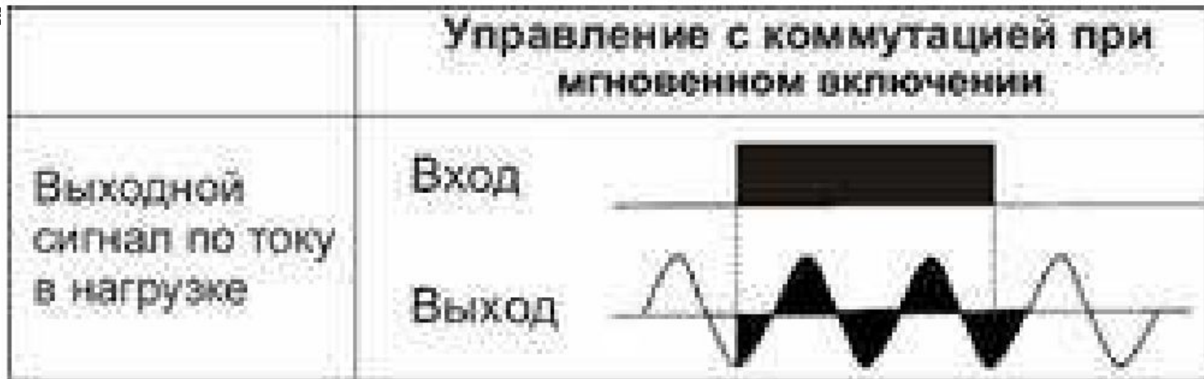
Диаграмма срабатывания ТТР мгновенного включения
