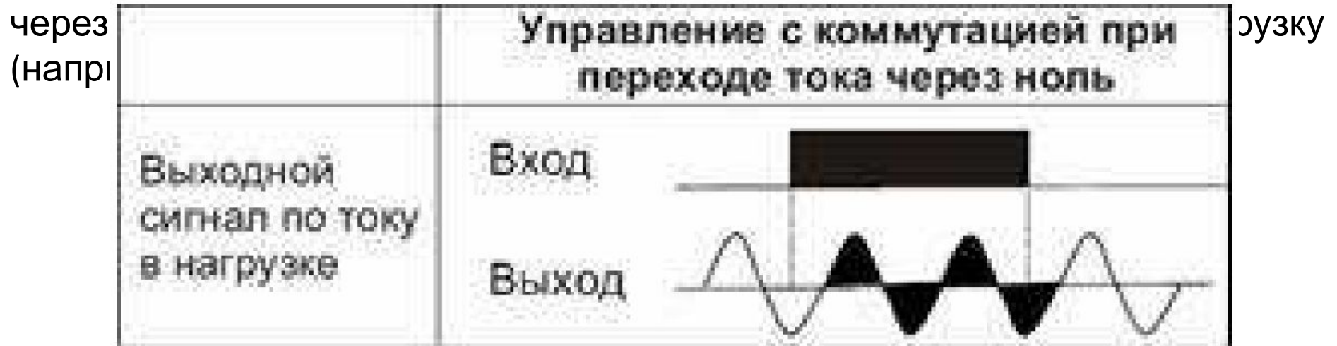
Диаграмма срабатывания ТТР с контролем перехода через ноль
