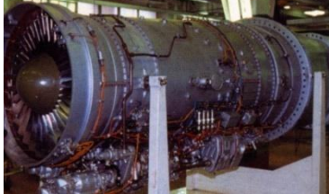
ТРДДФ Р79В-300 (1977г.) Первый в мире подъемно-маршевый двигатель с форсажем
