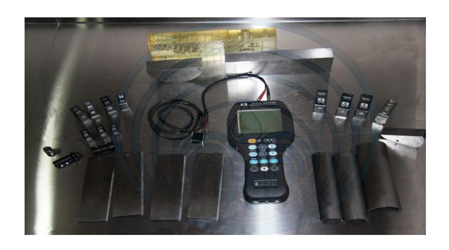
• Данная методика основана на электромагнитно-акустическом способе посылки и приёма ультразвуковых колебаний, что позволяет с высоким уровнем точности определить толщину измеряемого объекта. Это дает уникальную возможность с максимальной точностью определять толщину объекта, который подвергается измерению не нанося ему при этом каких-либо повреждений.
