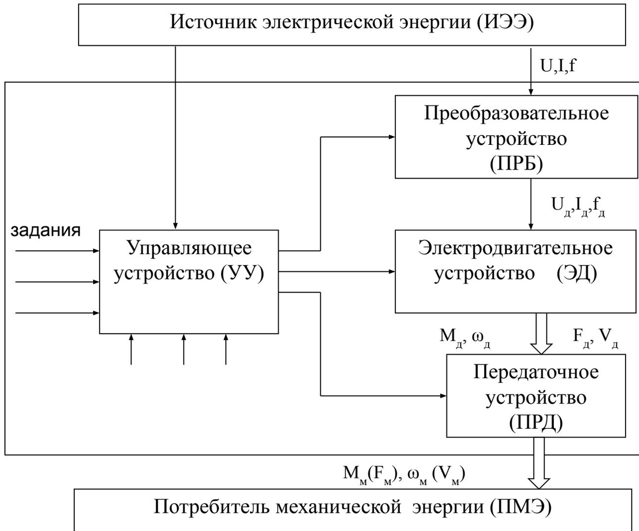
Рисунок 2. Структурная схема АЭП
